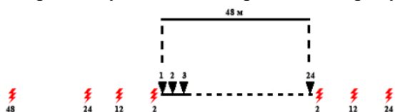
3-rasm. Seysmik to'liqlarni qabul qiluvchi geofonlarning joylashuvi sxemasi
